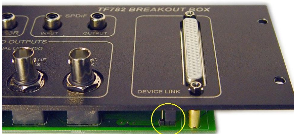
Рис. 11. Расположение контактов, используемых для заземления, на пассивной панели BREAKOUT BOX .
