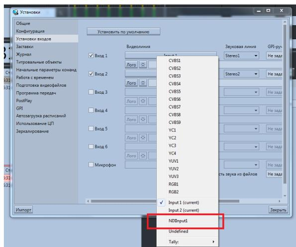
На закладке "Установки"->"Установки входов" выбираем из списка ранее настроенный вход с NDI-источника (в данном случае это NDIInput1).
