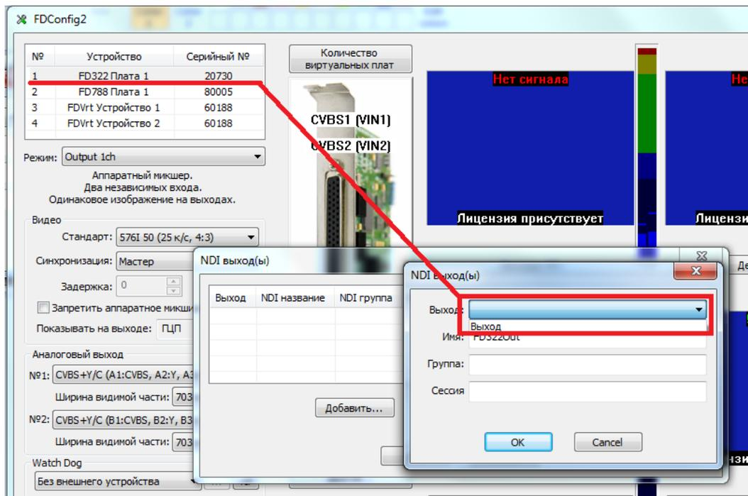
В диалоге "NDI выход (ы)" нажимаем кнопку "Добавить...". В списке "Выход" выбираем тот выход платы (реальной или виртуальной), для которой параллельно нужно формировать NDI-поток. В поле "Имя" выбираем название для этого потока. Остальные параметры ("Группа", "Сессия") являются не обязательными и, как правило, при работе не используются. Нажимаем кнопку "Ок", закрываем диалог "NDI выход (ы)".
