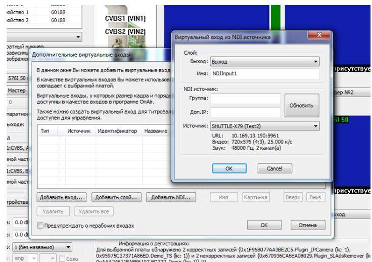
В диалоге "Дополнительные виртуальные входы" нажимаем кнопку "Добавить NDI...". В диалоге "Виртуальный вход из NDI источника" в списке "Выход" выбираем на каком выходе платы будет отображаться этот виртуальный вход. В поле "Имя" указываем его название для программы OnAir. Кнопка "Обновить" служит для обновления списка NDI-источников. В списке "Источник" выбираем тот NDI-поток, который хотим показывать. Запускаем программу OnAir.
