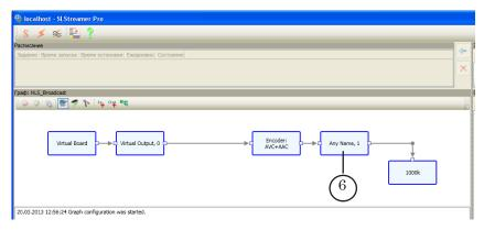
33. Если требуется организовать вывод данных в несколько потоков с разным качеством (битрейтом), то в граф необходимо добавить требуемое количество «веток», включающих входную программу, кодер, выходную программу, и выходное устройство (см. рис. ниже).
