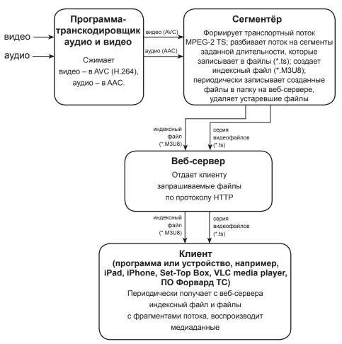
На базе продуктов линейки Форвард ТС могут быть реализованы решения как для приема, так и для передачи потоковых аудиовидеоданных с использованием технологии HLS.
