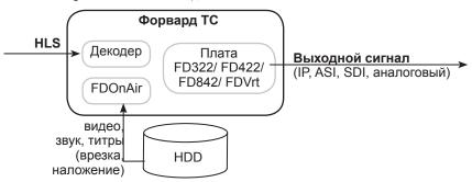
• прием HLS-потока и передача по UDP без перекодирования и изменения содержимого медиапотока.
