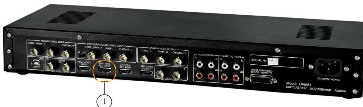
3. Присоедините контрольный монитор (HD-телевизор) к соответствующему видеовыходу модуля DVM81 (2): ANALOG VIDEO OUTPUT/SDI VIDEO OUTPUT/HDMI VIDEO OUTPUT. Соедините аудиовыход (3) модуля с монитором.
