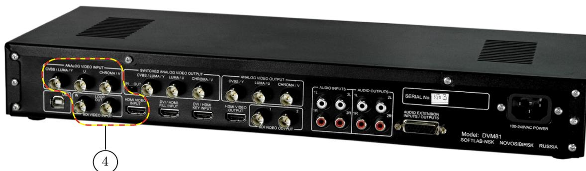
5. Соедините USB-разъем модуля DVM81 (5) с USB-портом управляющего компьютера.
