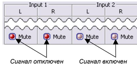
Рис. 6. Отключение входных сигналов
