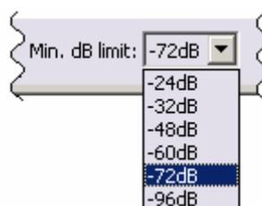
Рис. 20. Выбор масштабирования регуляторов громкости
